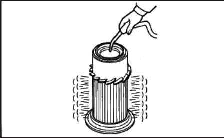
Şekil.11.5. Hava filtre elemanının temizlenmesi
