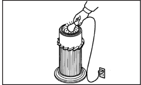
Şekil.11.6. Hava filtre elemanının kontrol edilmesi
