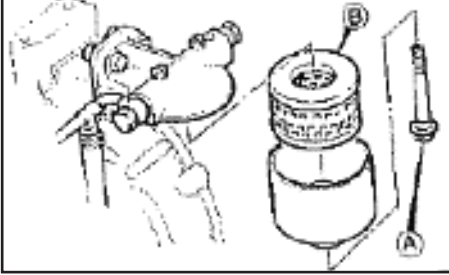
Şekil.11.3. Yakıt filtre elemanının değişimi; A: Filtre elemanı montaj civatası, B: Filtre elemanı
